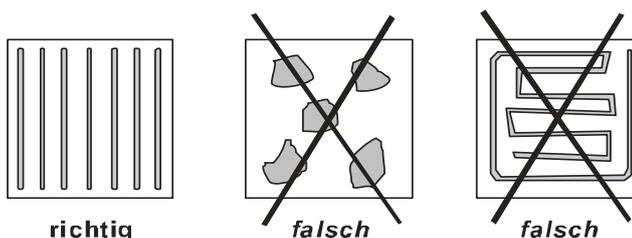
Den Klebstoff in vertikalen Raupen auftragen und nicht zu flach drücken. Um dies in der Praxis zu gewährleisten, empfehlen wir bei kritischen Anwendungen zusätzlich ein Wikofix PE-Vorlegeband, mit einer Dicke von rund 3 mm zur gleichmässigen Distanzierung zu verwenden. Empfohlener Raupenabstand: ca. 10 - 20 cm.
